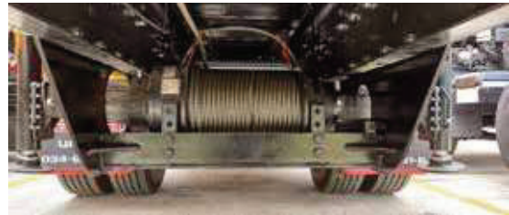
Verricelli idraulici da recupero epicicloidali Planetary hydraulic recovery winches
